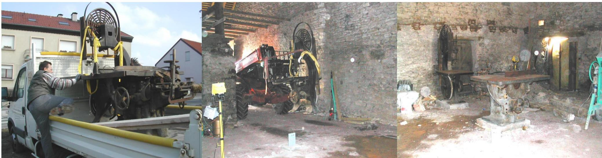
**Transport (avec l'aide de la Sté M&O) de la scie à ruban et de la raboteuse pour les installer sur les socles en béton avant de couler la dalle dans la grange**
