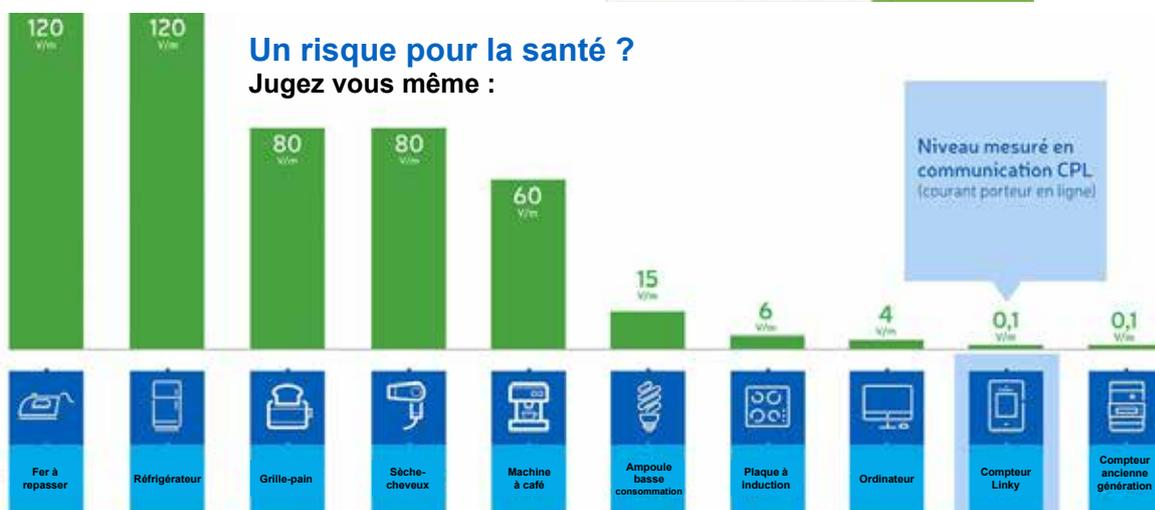
Champ électrique en Volt/mètre mesuré à proximité de l'appareil
